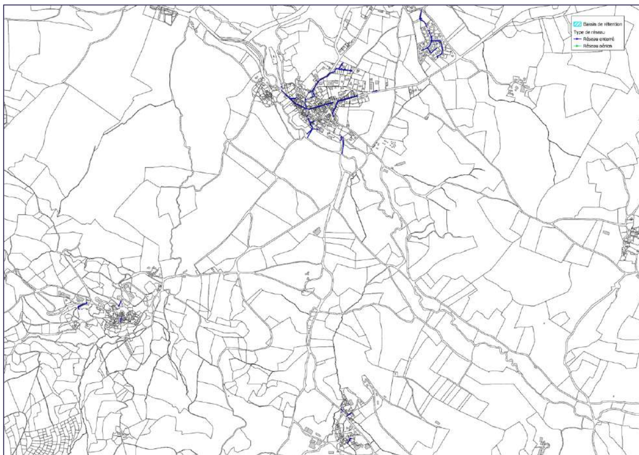
Figure 17 : Plan du réseau pluvial de Recoules-Prévinquières – 3.4 km (plan SIG transmis par la commune)
