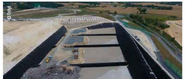
Le bioréacteur permet de transformer les ordures ménagères (sac noir) en énergie. Il s'agit d'un ensemble de casiers étanches, dans lesquels la dégradation des déchets est accélérée permettant la production de biogaz. Le biogaz, contenant près de 50% de méthane, est capté puis valorisé. Au Pôle des Énergies Renouvelables de TRYFIL, le biogaz issu de ces déchets est transformé en électricité, en chaleur, en biométhane-carburant et en hydrogène.
